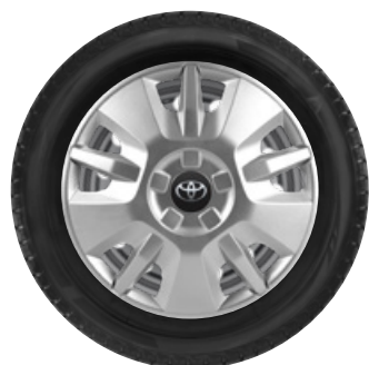
15" ezüstsínnű acél keréktárcsák 215/70 R15C méretű gumibroncsokkal és dísz tárcsákkal.
